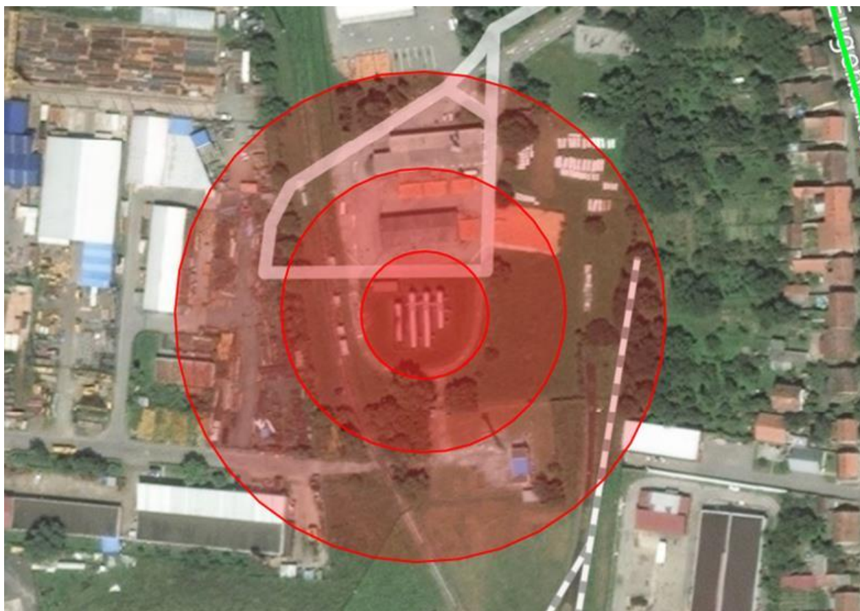
Slika 31: BLEVE horizontalni spremnik (150 m 3 UNP-a, zone 0,55 bar, 0,24 bar, 0,7 bar), (Uz dopuštenje DUZS, ZEOS)
