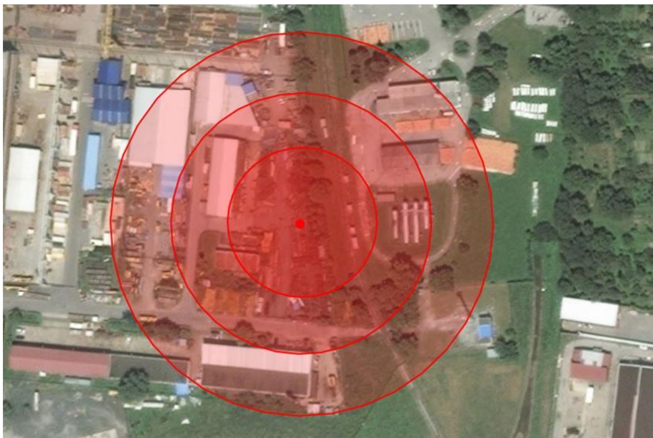
Slika 34. Kasna eksplozija s frontom oblaka 50 m udaljenosti od izvora disperzije (Uz odobrenje DUZS, ZEOS)
